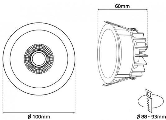
Totalmente construído em policarbonato, o MAIA alia a eficiência dos seus LEDs de alta luminosidade a uma estética subtil, moderna e funcional. De fácil instalação, vem equipado com um driver externo de conexão rápida. É um Downlight com selo PRO, tendo sido idealizado e projetado para ser a melhor solução nos ambientes mais exigentes.
